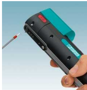
Mobiler Crimpautomat, für Abisolieren und Crimpen in einem Arbeitsgang CRIMPHANDY
