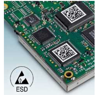
Rollenmaterial-Gerätemarkierung, zum Aufkleben für ESD-Anwendungen, zur Bedruckung mit Thermotransfer-Rollendruker EML-ESD... Seite 336
