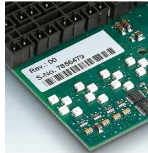
Rollenmaterial-Gerätemarkierung, zum Aufkleben für Hochtemperaturanwendungen, zur Bedruckung mit Thermotransfer-Rollendruker EML-HT... Seite 335
