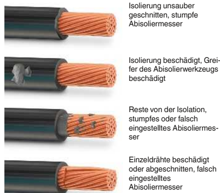
Abisolierfehler nach DIN IEC 60352-2
